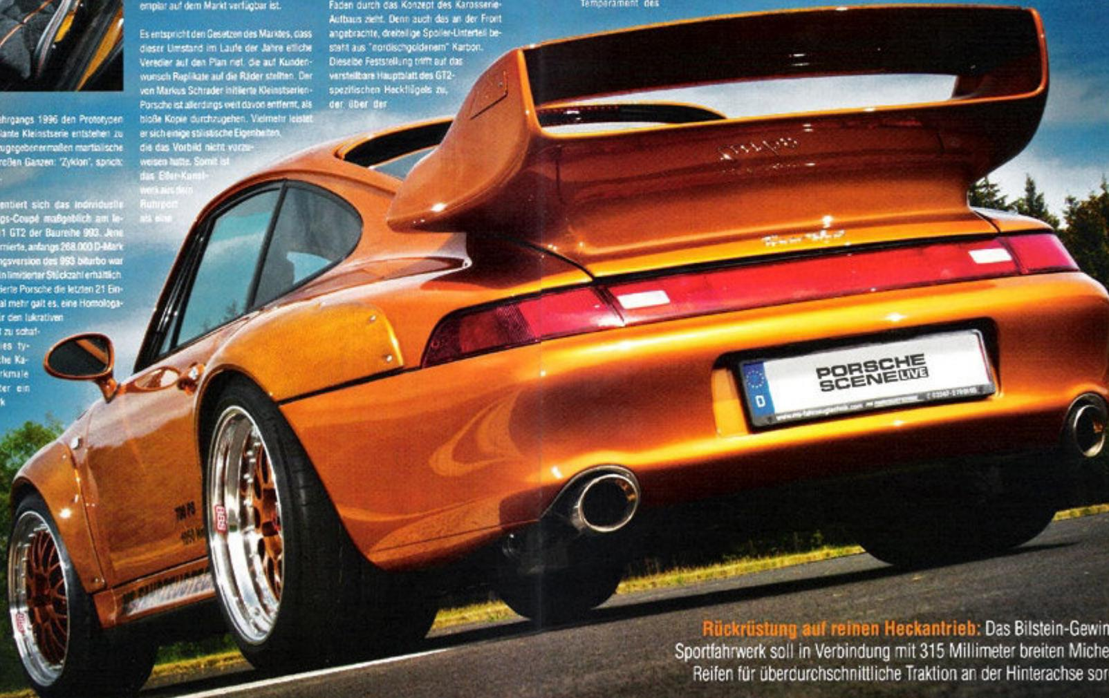
**Rückrüstung auf reinen Heckantrieb:** Das Bilstein-Gewinde-Sportfahrwerk soll in Verbindung mit 315 Millimeter breiten Michelin-Reifen für überdurchschnittliche Traction an der Hinterachse sorgen
